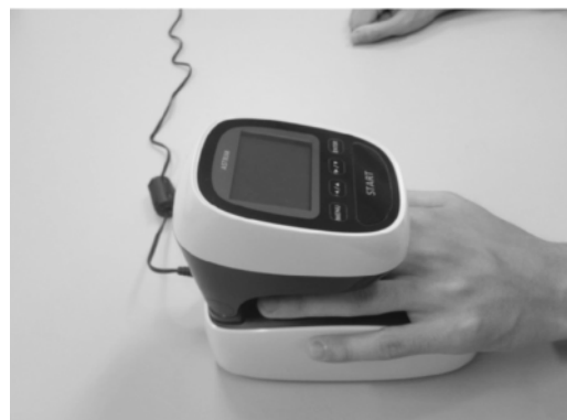
図3 近赤外分光画像計測法 (ASTRIM) による末梢血液中ヘモグロビン推定量の測定
